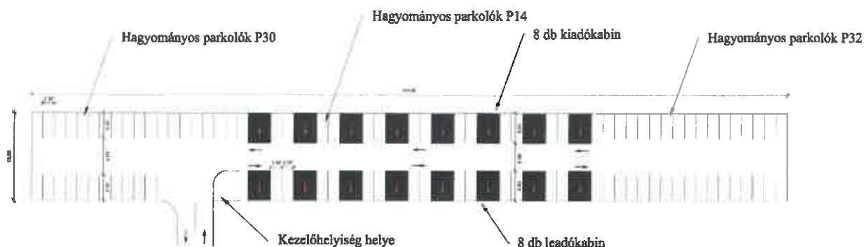
5-7. ábra: 16 kabinos automata rendszer fogadószintjének elvi elrendezése
